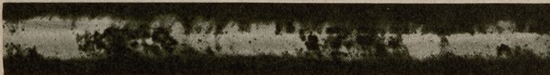
Ryc. 4. Spoina wadliwa; widoczne pory (szczeliny), zatajone żuźle, błędy spoiwości w szwie spawanym (w odróżnieniu od następných zdjęć mamy tu negatyw).
