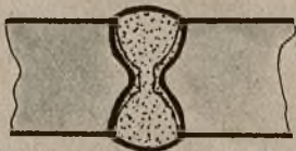
spoina czołowa na podwójne U dla blach bardzo grubych
