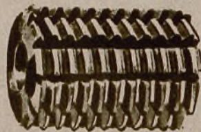
Rys.7 Frez modułowy ślimakowy do obróbki kół zębatych na frezar- ce obwiedniej.
