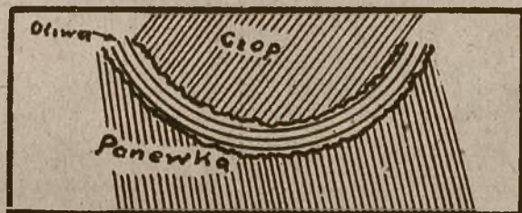
Ryc. 1. Warstewka oliwy zapełnia nierówności panewek które są znaczne, gdy je obserwujemy pod mikroskopem.
