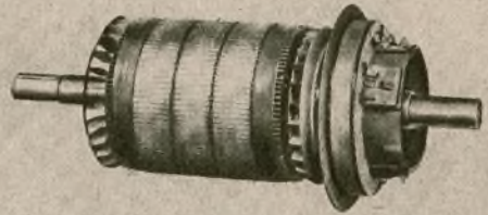
Ryc. 4. Wirnik silnika z rozrusznikiem odśrodkowym.
