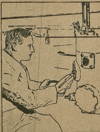
Ryc. 5. Przed zamknięciem wiazów należy posmarować gwint mieszanką z oleju i grafitu.
