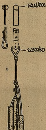
Ryc. 23. Sposób założenia drutów przeciągadła.
