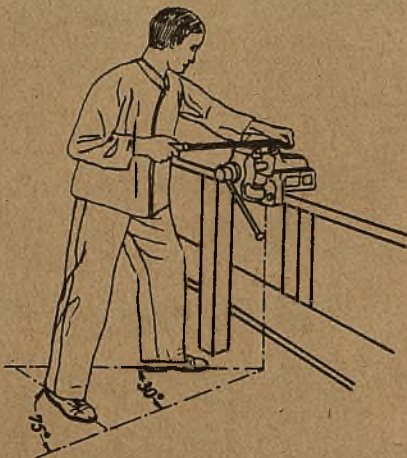
Prawidłowa postawa ślusarza na początku i końcu ruchu przy pitowaniu ciężkim pilnikiem. (Konieczny - ruch całego korpusu).
