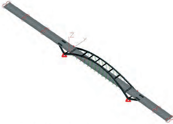
Rys. 21. Model MES mostu w Puławach. Fig. 21. FEM model of bridge in Pulawy.
