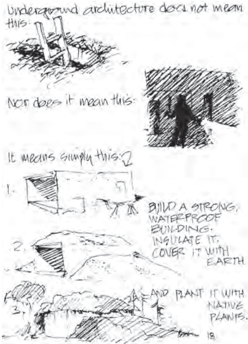
Rys. 7. Szkic Malcolm'a Wells'a przedstawiający definicję pojęcia „architektury podziemnej”. Fig. 7. Sketch of Malcolm Wells showing the definition of 'earth sheltered architecture'.
