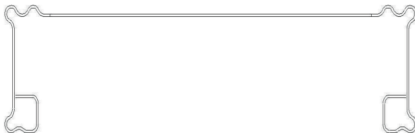
Rys. 2. Przekrój poprzeczny pomostu stalowego firmy ALTRAD MOSTOSTAL.
