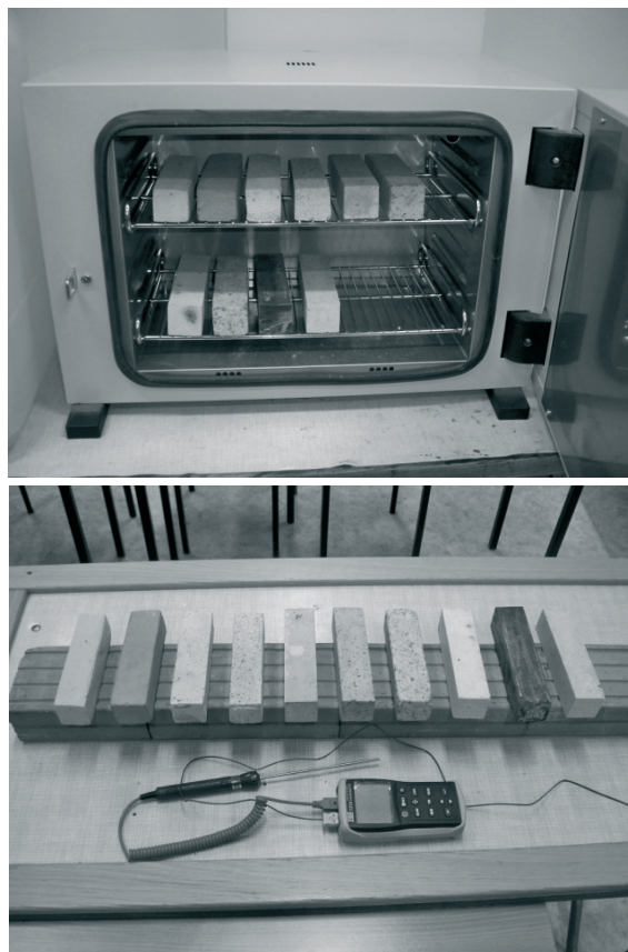
Rys. 1. Próbki użyte do badań: a) w suszarce laboratoryjnej, b) na stanowisku pomiaru temperatur.
