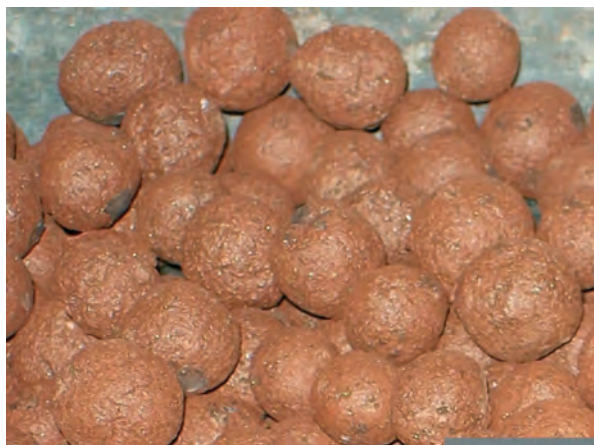
Fot. 1. Kruszywo keramzytowe otrzymane poprzez wypalenie w temperaturze 1170°C.
