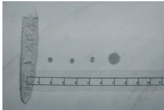
Rys. 2. Próbką III 10. Pomiar promienia penetracji preparatu w opoce. Fig. 2. Sample III 10. The radius of penetration measurement.
