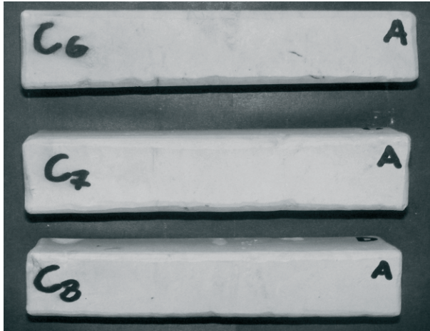
Rys. 4. Wycięte i przygotowane do badań próbki strefy C. Fig. 4. Cut and prepared samples from zone C for test.
