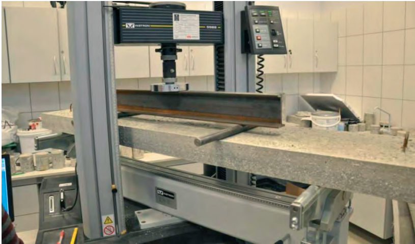
Rys. 5. Próbką żelbetowa w trakcie próby niszczącej
