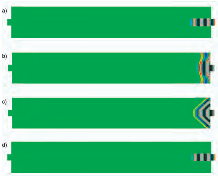
Rys. 7. Propagacja fali (składowa v_z – wzdłuż osi pręta) w chwili czasowej t = 2,8e-5 s w prętach otoczonych: a) powietrzem b) E = 37 GPa; c) E = 5 GPa; d) E = 0,5 GPa
