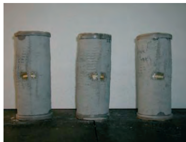
Rys. 7. Obraz zniszczenia elementów typu z/u=0,4
