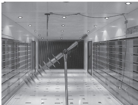
Rys. 8. Model wirnika jednołopatowego typu Magnusa z przeciwwagą w tunelu aerodynamicznym LIWPK[1]
