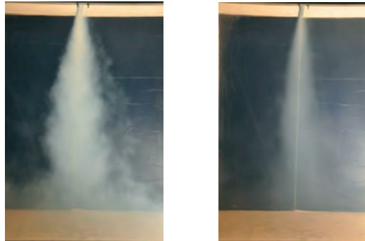
Rys. 8 Wizualizacja strugi nawiewanego po lewej 10,0 m/s, po prawej: 30,0 m/s
