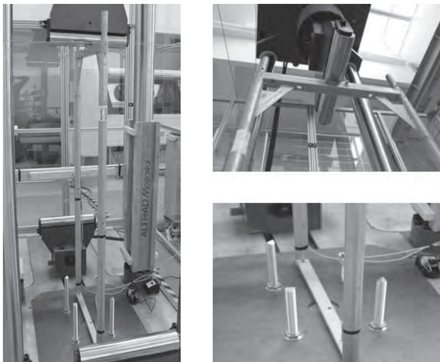
Rys. 7. Stanowisko do obciążania ramy systemu fasadowego rusztowań.
