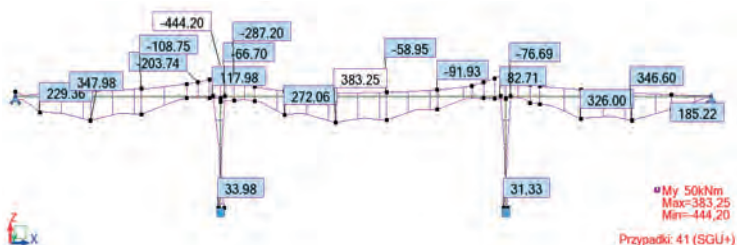
Rys. 5. Obwiednia momentów od obciążenia K+q [7]
