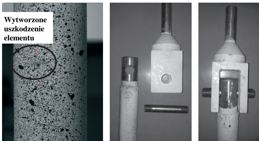
Rys. 3. Wycinek rury przygotowany do obciążenia siłą osiową.
