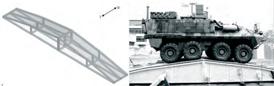
Rys. 5. Schemat konstrukcyjny koleiny przęsła oraz widok przęsła podczas badań pod obciążeniem pojazdem Bison (MLC 16) [13]
