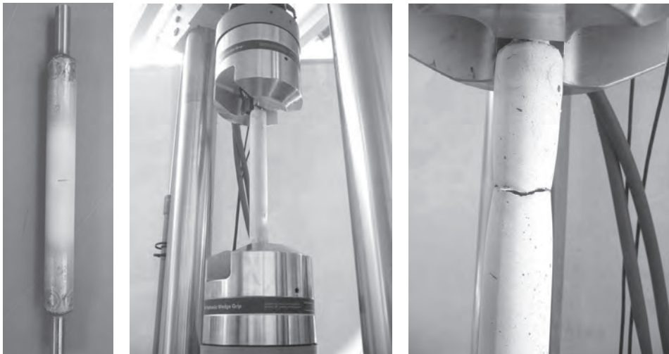
Rys. 1. Wycinek rury przygotowany do obciążenia siłą osiową.
