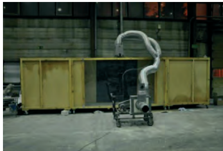
Rys. 6. Tunel do badania kurtyn powietrznych.
