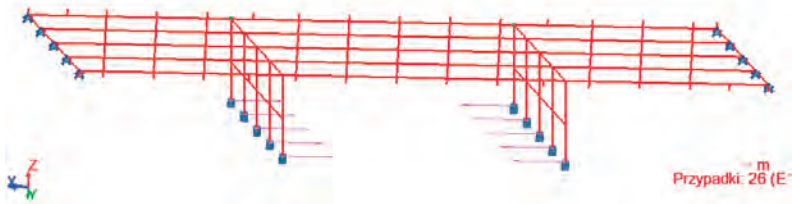
Rys. 8. Modelowanie poziomych deformacji terenu jako przemieszczeń węzłów podporowych
