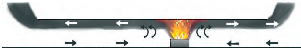
Rys.1. Przepływ mieszaniny dymu i powietrza w tunelu o prędkości przepływu powietrza bliskiej zeru
