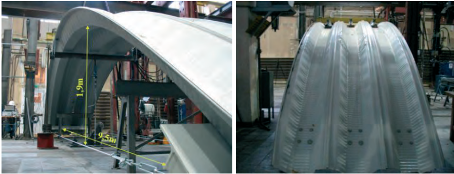
Rys. 4. Element badawczy zadaszania łukowego ABM 240 [16]
