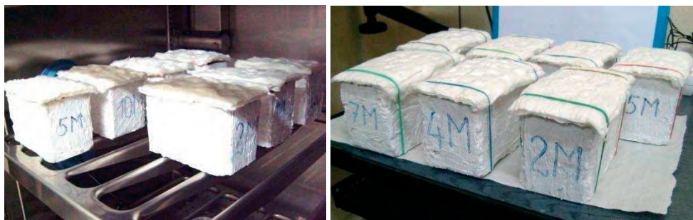
Rys. 5. Badany układ: okład z ligniny – cegła ceramiczna
