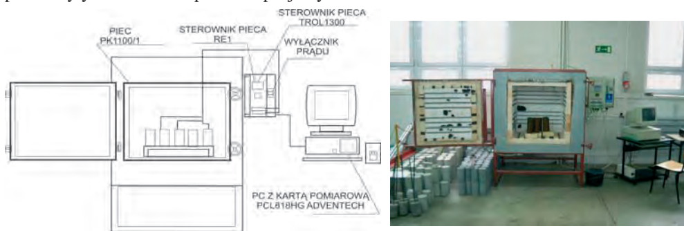
Rys.. 2. Stanowisko badawcze: schemat stanowiska i fotografia pieca z przygotowanymi próbkami
