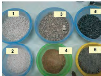
Rys. 1. Kruszywa użyte w badaniach: 1 – kruszywo z ceramiki sanitarnej – frakcja gruba, 2 – kruszywo z ceramiki sanitarnej - frakcja drobna, 3 – żwir, 4 – piasek, 5 – kruszywa granitowe - frakcja gruba, 6 – kruszywo granitowe - frakcja drobna
