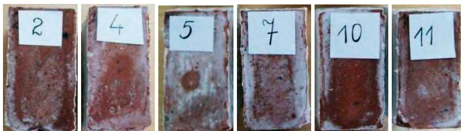
Rys. 6. Powierzchnia próbek po procesie odsalania
