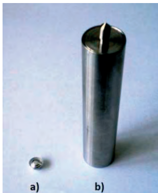
Rys. 1. Porównanie naczyń pomiarowych stosowanych do badań kalorymetrycznych a) naczynie dla próbek o wadze kilkuset miligramów b) naczynie zastosowane w badaniach
