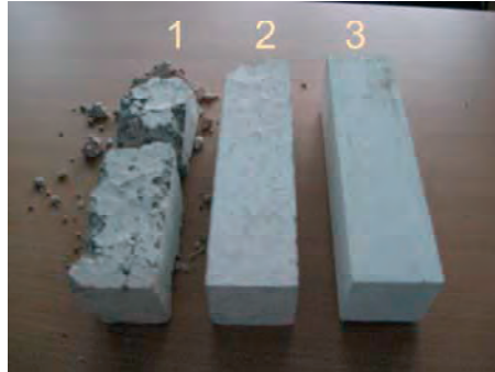
Rys. 5. Próbkę drugiego etapu badań po 30 dniach od wygrzewania: 1 – próbki z betonu na cemencie glinowym i kruszywie pisakowo-żwirowym, 2 – próbki na cemencie glinowym i kruszywie granitowym, 3 – próbki na cemencie glinowym i kruszywie z odpadów ceramiki sanitarnej
