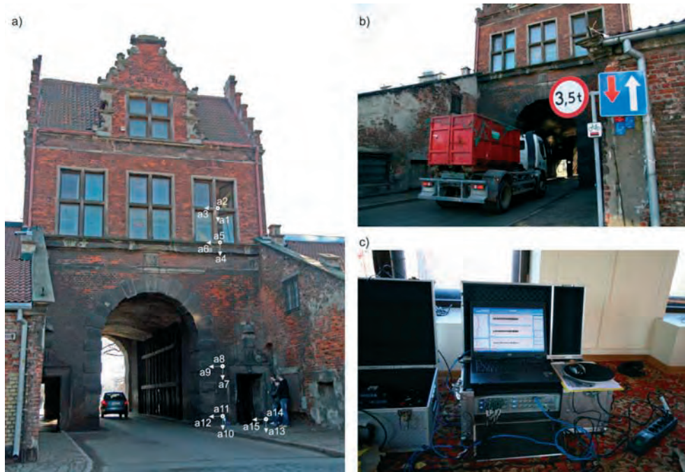
Rys. 7. Brama Nizinna: a) rozmieszczenie punktów pomiarowych na elewacji północnej; b) wymuszenie dynamiczne; c) sprzęt pomiarowy
