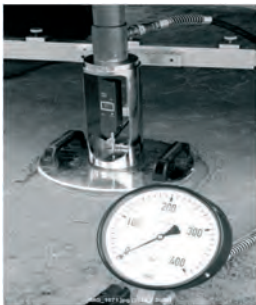
Rys. 4. Badania modułów odkształcenia podłoża płytą VSS.
