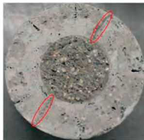
Rys. 7. Widok pękniętej próbki po badaniu odporności na pękanie.
