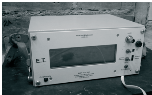
Rys. 4. Przenośny miernik TDR (FOM - Field Operated Multimeter).
