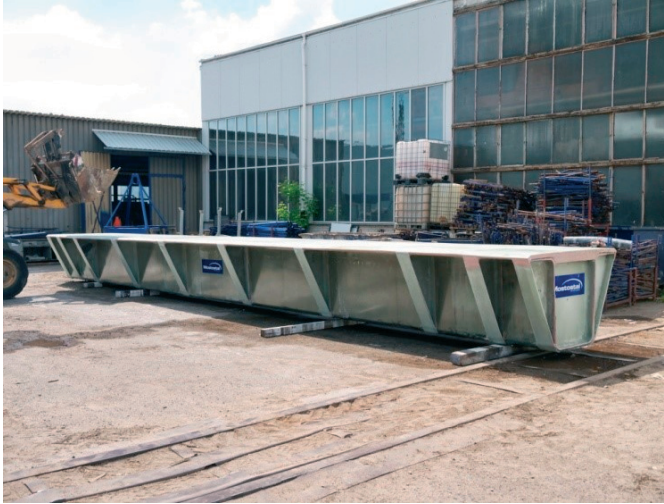
Rys. 3. Model dźwigara kompozytowego przygotowany do badań wytrzymałościowych
