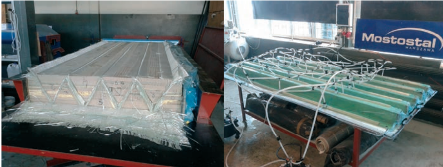
Rys. 2. Zastosowanie technologii infuzji próżniowej do wykonania paneli kompozytowych. Po lewej układanie tkanin zbrojących panelu II w formie, po prawej część panelu III podczas infuzji żywicą
