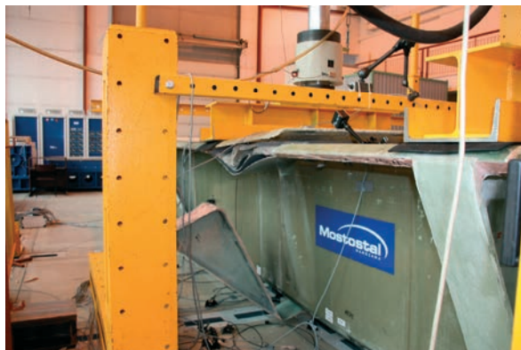
Rys.8. Podstawowa postać zniszczenia dźwigara
