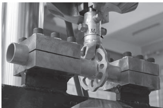
Rys.2. Uchwyt zastosowany w przypadku skręcania rygla M_x
