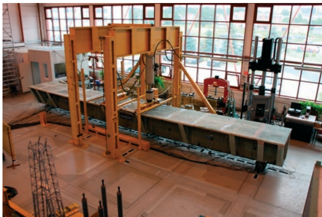
Rys. 4. Model dźwigara kompozytowego na stanowisku badawczym
