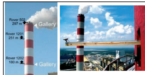
Rys. 4. Lokalizacja 3 anten GPS typu „rover” na kominie i sposób ich instalacji do elementów poziomych w dniach 20-24.05.2011r.
