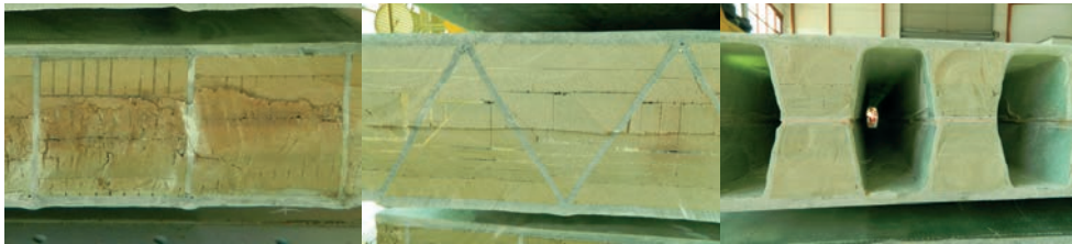
Rys. 3. Przekroje poprzeczne paneli (od lewej) I, II i III oraz widoczne deformacje w strefach połączeń żeber z arkuszami powierzchniowymi
