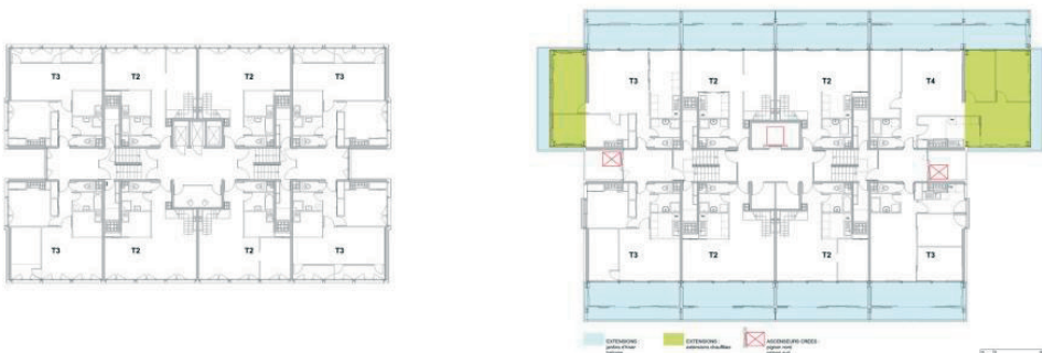
Rys. 7. Rzut kondygnacji powtarzalnej przed i po przebudowie [10]
