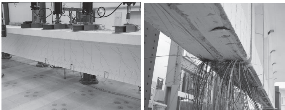
Rys. 5. Widok dźwigara referencyjnego (lewa) oraz wzmocnionego (prawa) po zniszczeniu
