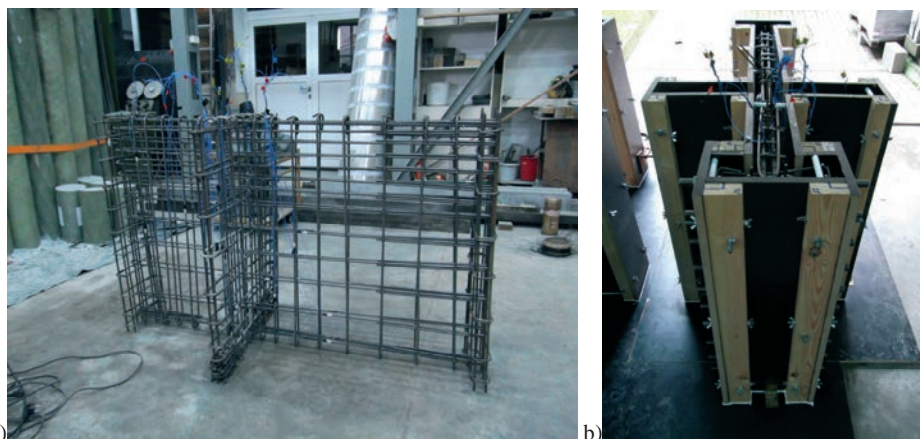
Rys. 2. Przygotowania elementu badawczego: a) zbrojenie z rozmieszczonymi tensometrami b) tarcza przed betonowaniem
