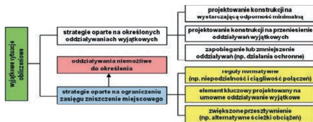
Rys. 1. Strategie dotyczące zapewnienia bezpieczeństwa obiektów budowlanych wg [4]
