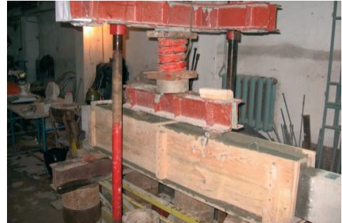
Rys. 4. Belka podczas obetonowywania
