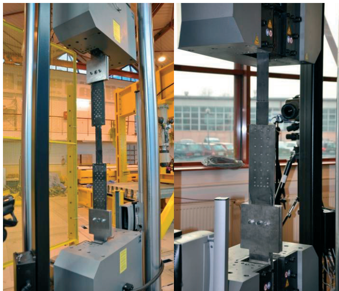
Rys. 4. Badanie zakotwień serii S1 i S3 w maszynie wytrzymałościowej
