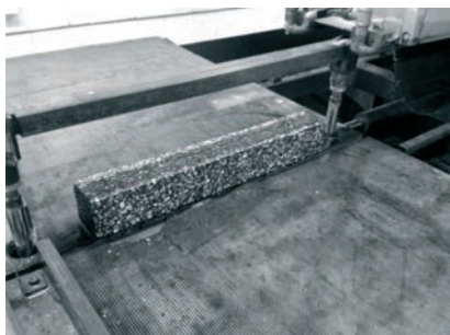
Rys. 2. Widok wycinania próbek z zagęszczonych płyt z mieszanki mineralno-asfaltowej
