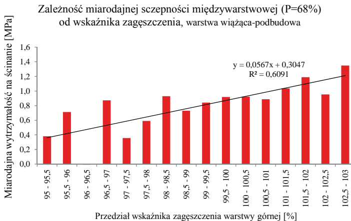
Rys. 6. Miarodajna wytrzymałość na ścinanie w zależności od wskaźnika zagęszczenia warstwy wyżej leżącej, próbki odwiercone z nowobudowanych nawierzchni – 1148 próbek
