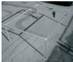
Rys. 2. Stanowisko pomiarowe z zamontowanym dalmierzem laserowym
