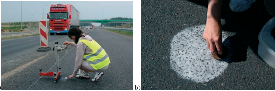
Rys. 1. Wykonywanie pomiaru a) wahadłem angielskim, b) makrotekstury
