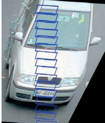
Rys. 3. Detekcja tablicy rejestracyjnej przez system ANPR
