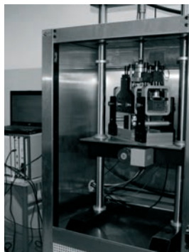
Rys. 1. Uniwersalne urządzenie UTM-25 do badań zmęczeniowych mieszanek mineralno-asfaltowych
