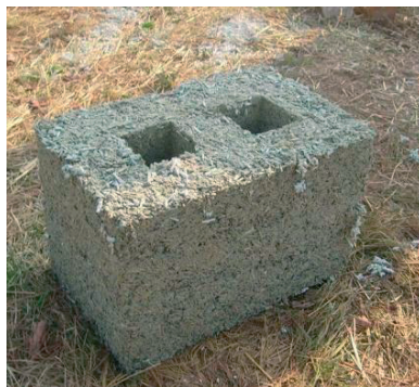
Rys. 6. Bloczek ścienny wykonany z kompozytu wapienno-konopnego [archiwum autorów]
