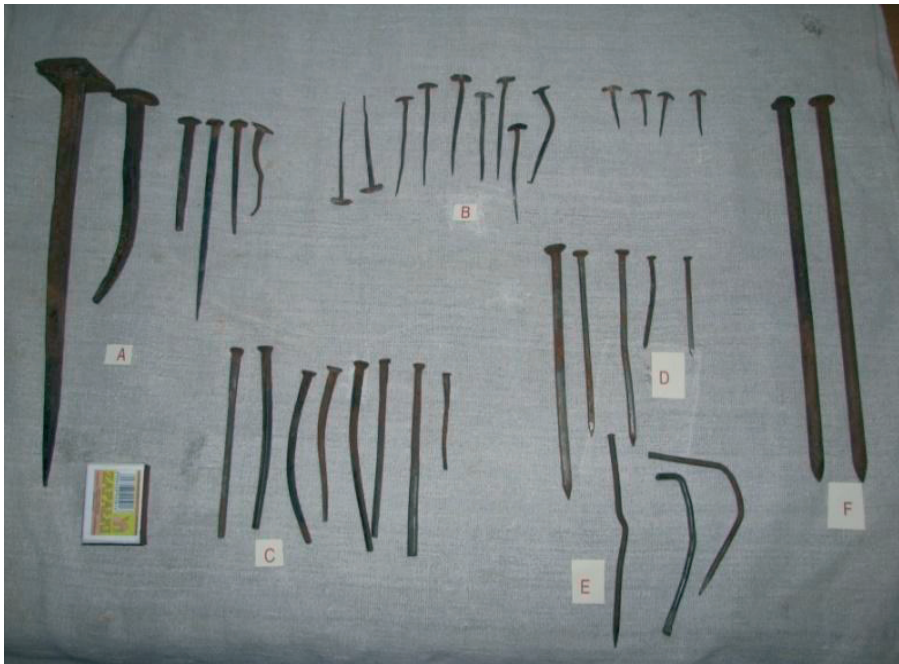
Fot. 11. Typy gwoździ żelaznych stosowane do poł. XX wieku w Polsce; fot.K.Wieczorek, ze zbiorów autora. Gwoździe kowalskie (A), gwoździe "motylkowe" z pierwszej poł. XIXw.(B), gwoździe cięte ,z okresu po 1862r.(C), gwoździe międzywojenne o przekroju kwadratowym(D), gwoździe robione z terenów Podlasia zajętych przez ZSRR w 1939r.(E), gwoździe powojenne o przekroju okrągłym (F)
