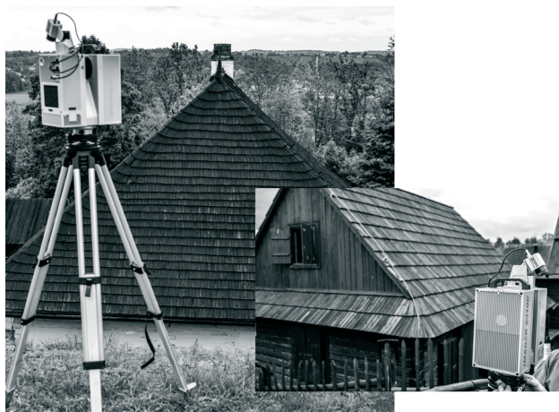
Ryc. 4. Fotografie poglądowe z pomiarów wykonanych przy drewnianej architekturze wernakularnej – pomiary skanerem Zoller + Fröhlich IMAGER 5010C. W tle „dom pogrzebowy” kryty gontem oraz połac dachowa dawnej karczmy z 1830 r. (gont). Skansen w Dobczycach. [Fot. R. Zapłata]
