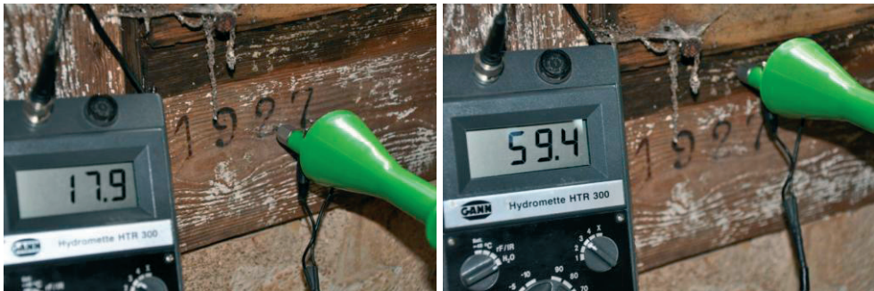
Fot. 1. Wilgotność tego samego, zalewanego wodą elementu. Strefa bielasta – wilgotność 60% – optymalne warunki dla rozwoju grzybów. Strefa twardej – wilgotność 18% - suchy stan ochronny.
