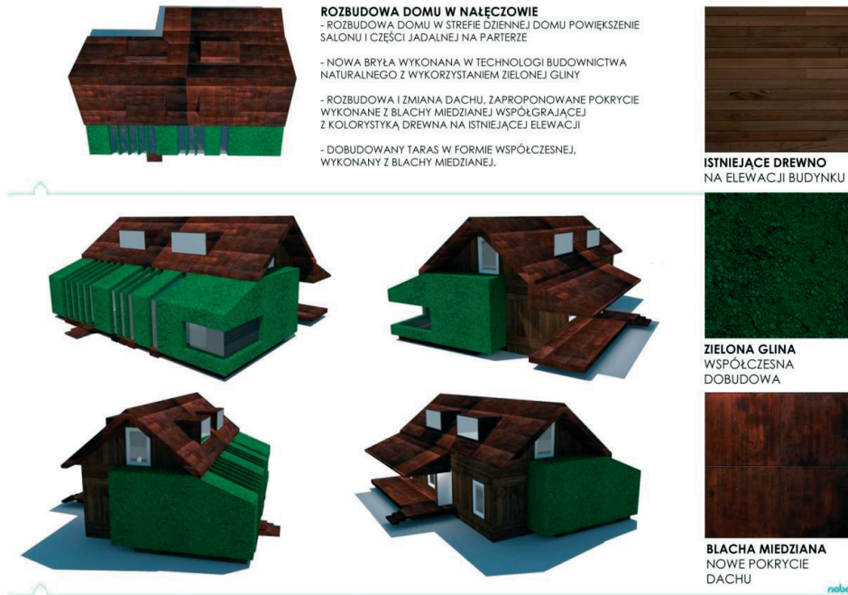
Rys. 22. Wizualizacja projektowanej dobudowy glinianego bloku do istniejącego drewnianego obiektu wernakularnego (aut. K. Skiba).
