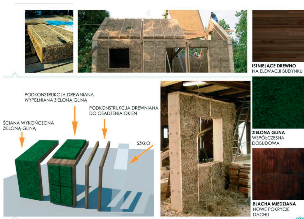
Rys. 21. Wernakularna technologia budowy z użyciem słomy i gliny (aut. K. Skiba).
