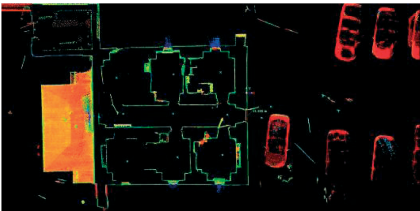
Rys. 11. Szpitalik – rzut na poziomie 110 cm – skan laserowy. Źródło: Oprac. własne we współpracy z dr. inż. arch. B. Kwiatkowskim
