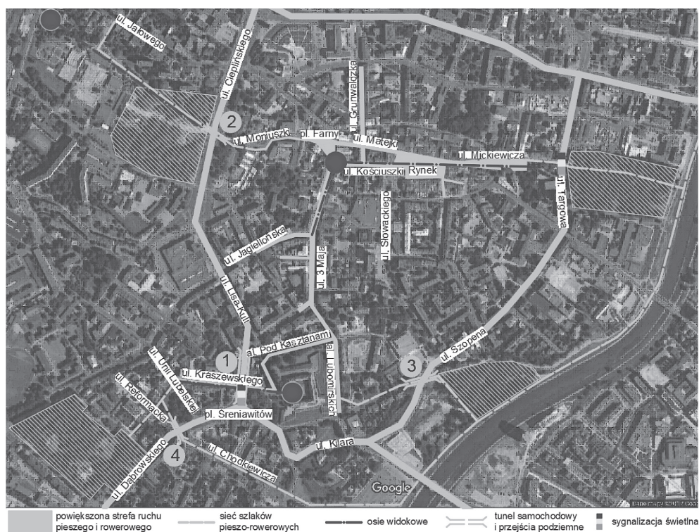
Rys. 2. Koncepcja rozbudowy przestrzeni publicznej oraz rozmieszczenie proponowanych obiektów inżynierskich: 1) tunel drogowy pod jezdnią ul. Lisa-Kuli, 2) tunel pieszo-rowerowy pod ul. Cieplickiego, 3) tunel pieszo-rowerowy pod ul. Szopena, 4) tunel pieszo-rowerowy pod skrzyżowaniem ul. Dąbrowskiego i ul. Reformackiej
