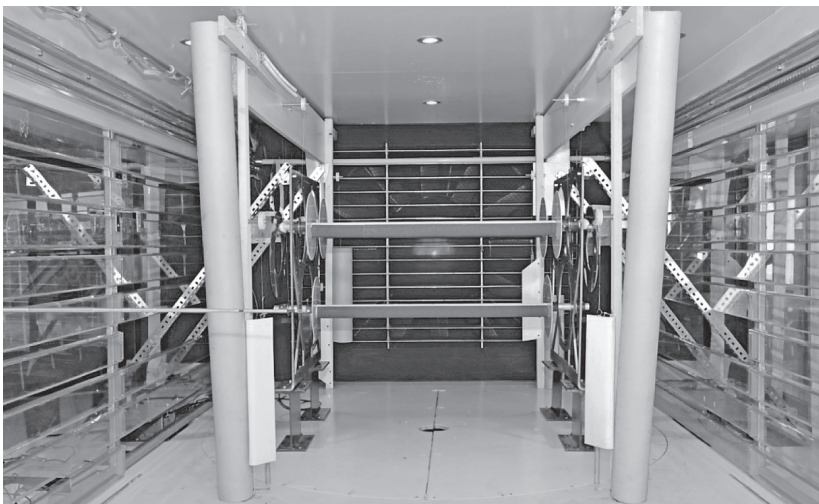
Rys. 7. Sekcyjny model aeroelastyczny w przestrzeni pomiarowej tunelu aerodynamicznego
