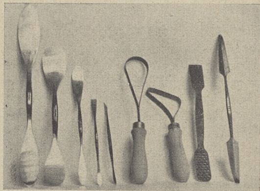
Ryc. 233. Łopatki i skrobacze do prac przy gipsowaniu.
