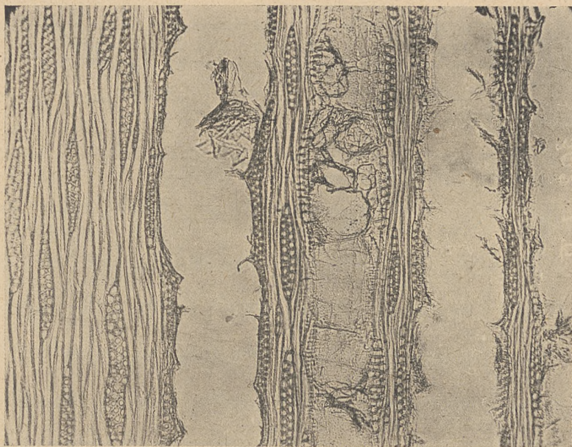
Ryc. 2. Przekrój styczny przez drewno jesiona. Widoczne naczynia o dużym świetle, włókna drzewne i promienie rdzeniowe. Powiększenie ok. 88.5 \times . Fot. Dr. Gorczyński.
