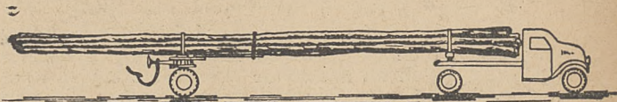
Rys. 8. Doczepy stosowane z ciągnikiem samochodowym z pokrętnymi ławami, do przewozu drewna długiego. (wg Gayer-Fabricus — Die Forstbenutzung).
