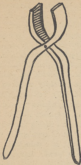
Rys. 4 — Schematyczny rysunek szczypiec do zgniatania gałek z poczwarkami żywiczanecki
