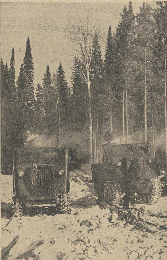
Obok mechanizacji pracy przy ścinie, zmechanizowany został w Związku Radzieckim również transport leśny. Na zdjęciu — gąsienicowe ciągniki KT-12 na gaz drzewny, używane również u nas do zrywki drewna w lesie.
