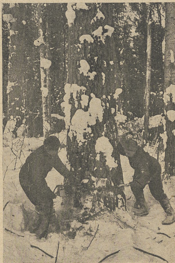
Związek Radziecki posiada 1100 mln ha lasów, czyli więcej niż jedną czwartą ogólnej powierzchni lasów na świecie. Właściwe wykorzystanie olbrzymich zasobów surowca drzewnego jest możliwe tylko dzięki daleko idącej mechanizacji pracy. Na zdjęciu — ścinka potężnej sosny elektryczną piłą mechaniczną.
