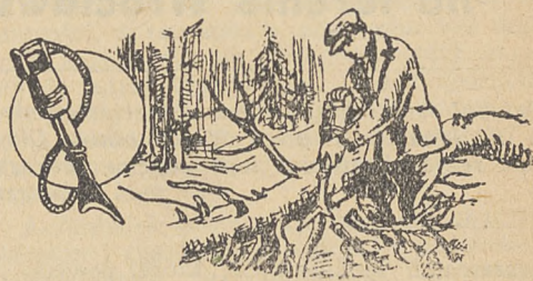
Siekiera elektryczna i praca nią na zrębie
