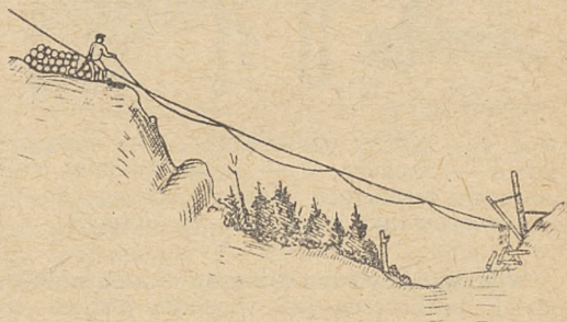
Ryc. 8 — Wciąganie wiązki pustych łańcuszków na górę za pomocą linki konopnej, podwieszanej w kilku miejscach na żelaznych pierścieniach
