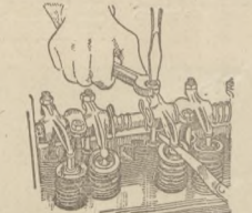
Regulacja luzów zaworowych w silniku górnozaworowym.
