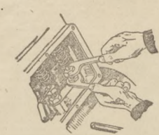
Regulacja luzów zaworowych w silniku dolnozaworowym.
