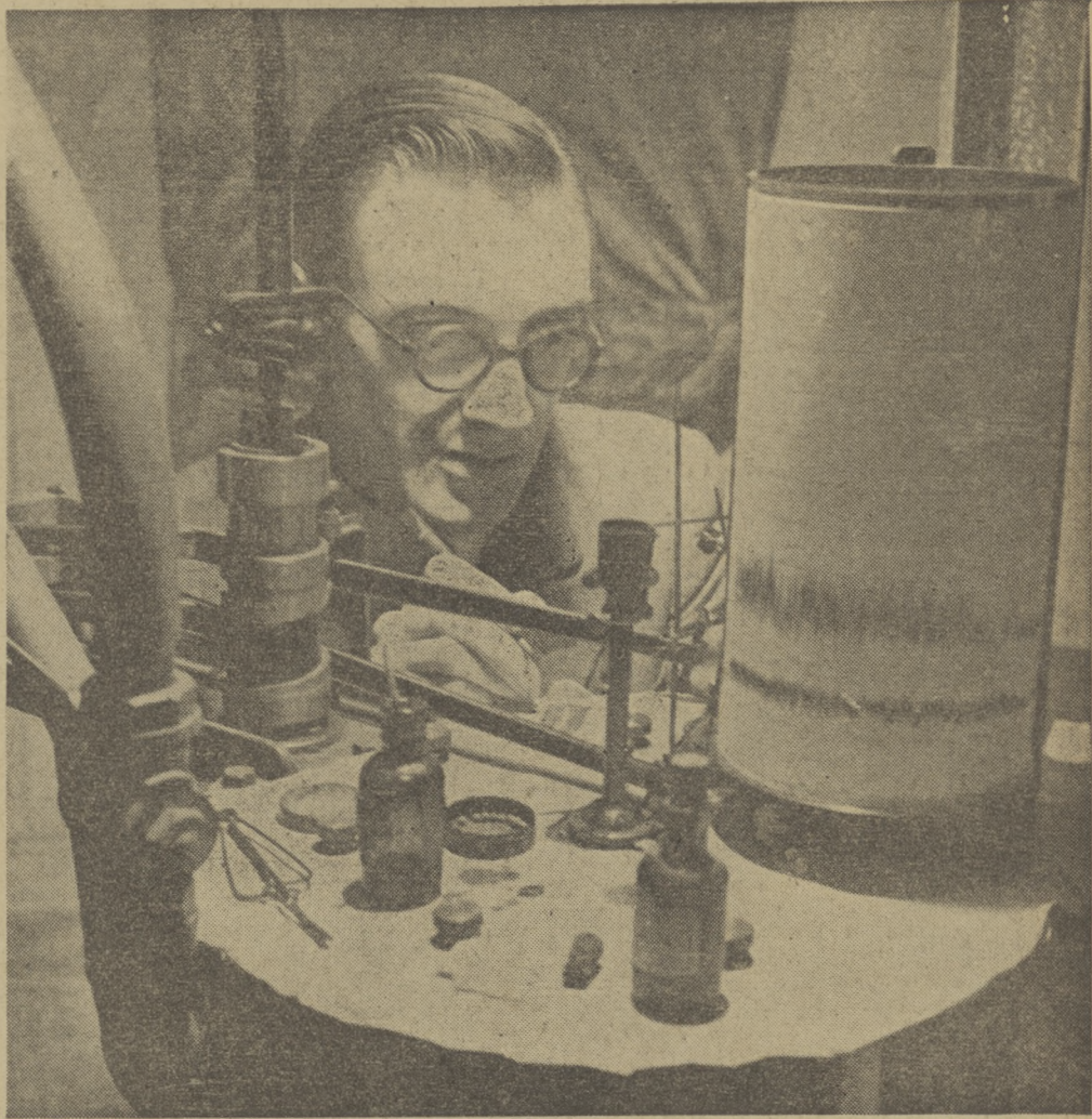
ODCZYTANIE Z ANEMOGRAFU KIERUNKU WIATRU I SZYBKOSCI.
