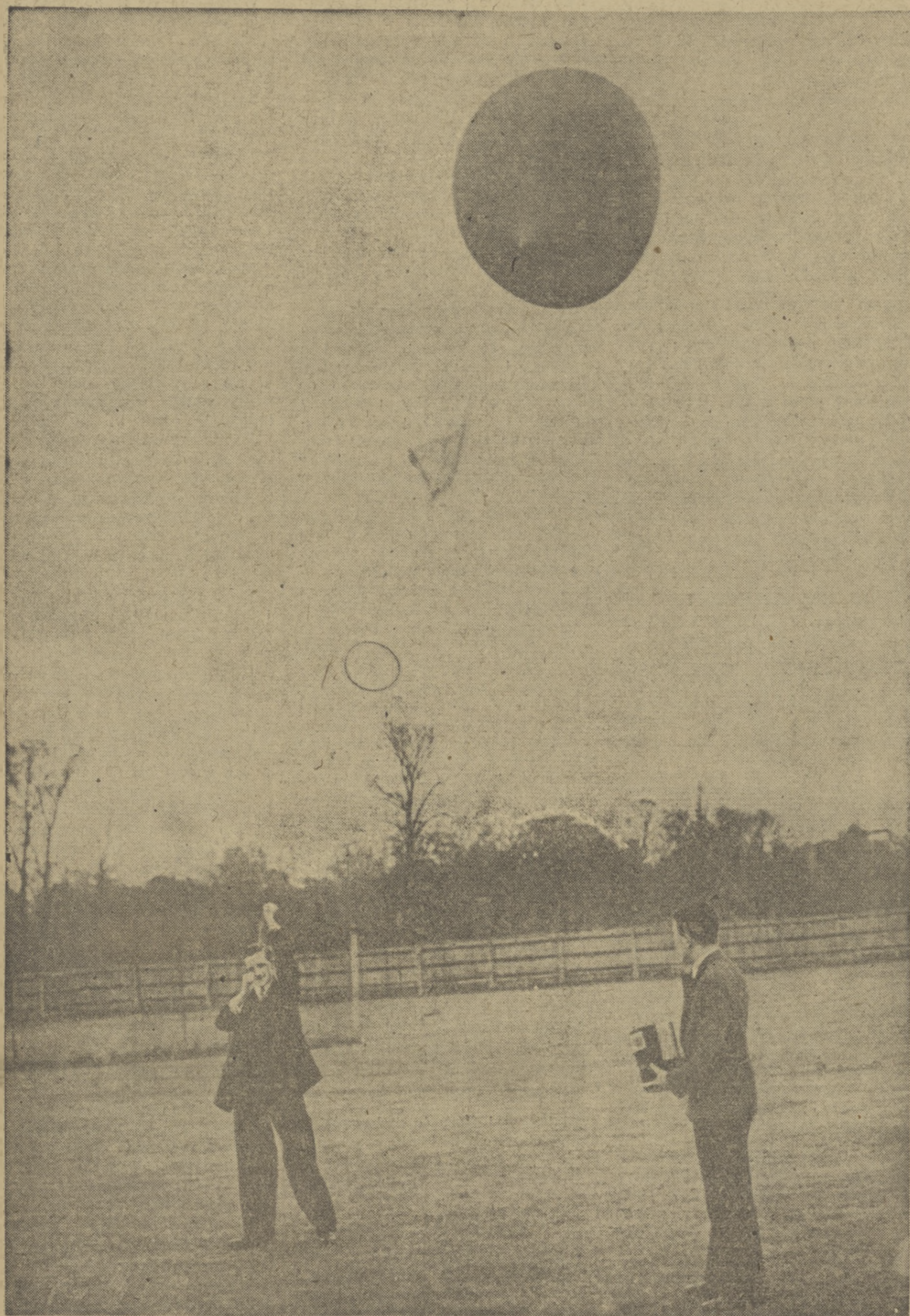
BALON Z RADIO-SONDĄ UNOSI SIĘ W GÓRĘ. KIEDY BALON WZNIESIE SIĘ NA WYSOKOŚĆ 18 KM PĘKA, A SPADOCHRON UMIESZCZONY PONIŻEJ BALONU, OTWIERA SIĘ AUTOMATYCZNIE I OPADA WRAZ Z RADIO-SONDĄ NA ZIEMIĘ.
