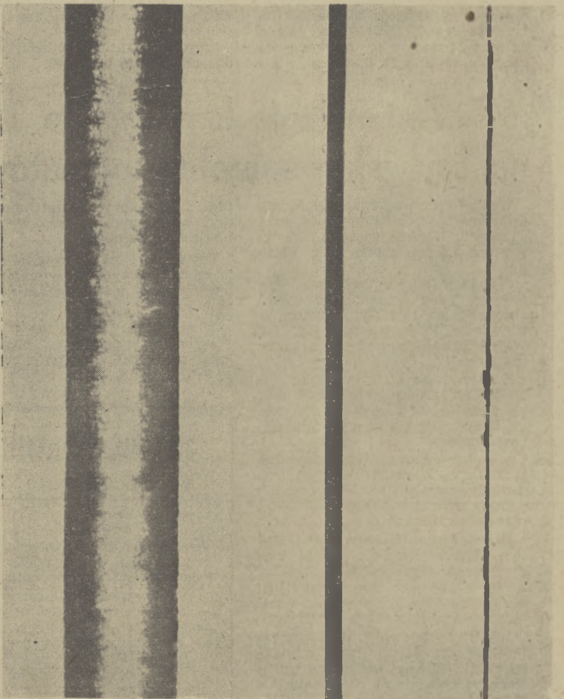
Cieniutki drut wolframowy o średnicy wynoszącej 1/100 mm w porównaniu z włosem ludzkim (na lewo) i nitką pajęczą (na prawo).
