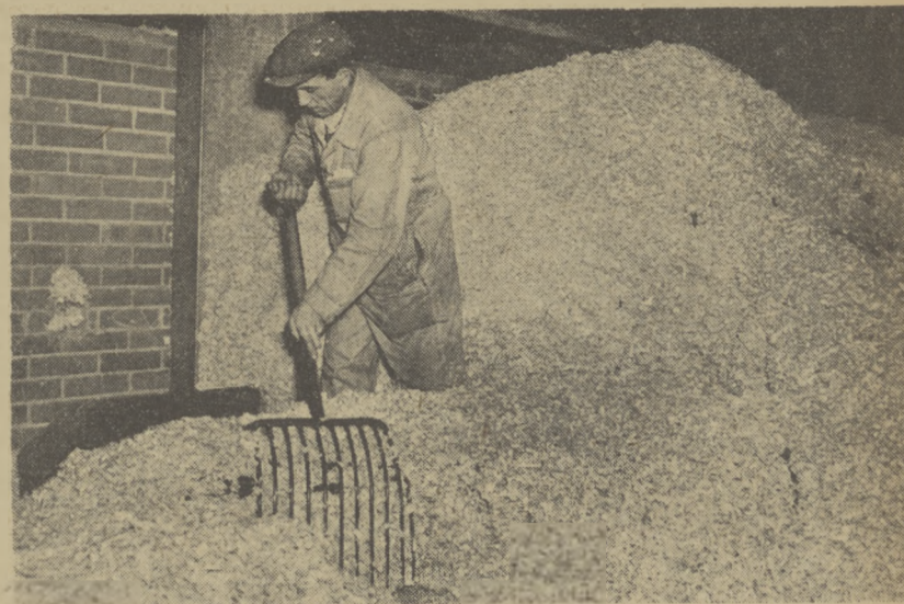
Robotnik przygotowuje surowiec — trociny i opilki — które zostaną przemieszane przez potężne rury ssące do zbiorników znajdujących się nad dachem fabryki.
