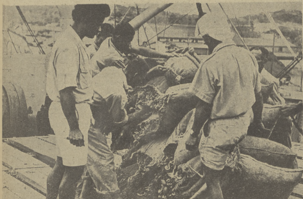
Kopre wsypuje się bez opakowania na dno okrętu. Na zdjęciu ładownicy okrętowi wypróżniają worki do luku pokładowego.
