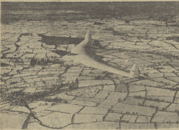
Latające skrzydło A. W. 52 wyposażone w dwa silniki odrzutowe „Rolls Royce Nene”
