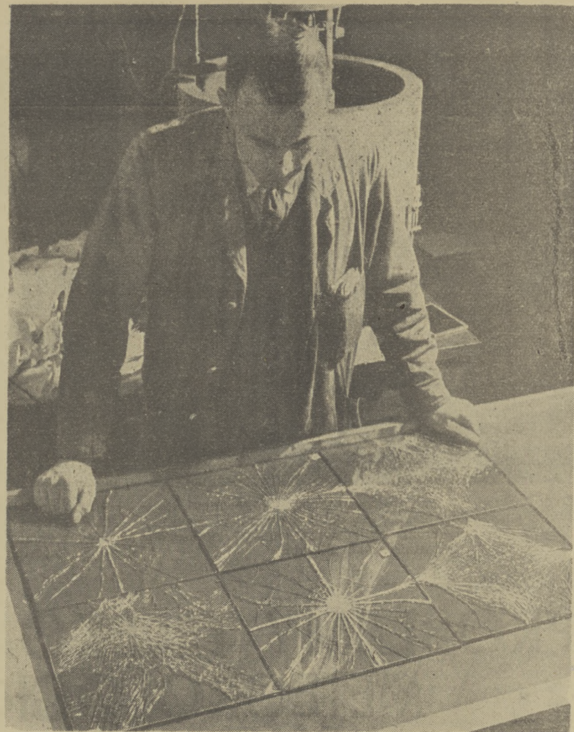
Wzory pięknie spowodowanych na płytach szklanych uderzeniem kulek stalowych jednakowej wielkości. Próby wytrzymałości szkła na pęknięcia przeprowadza stale wydział technologii szkła na uniwersytecie w Sheffield.
