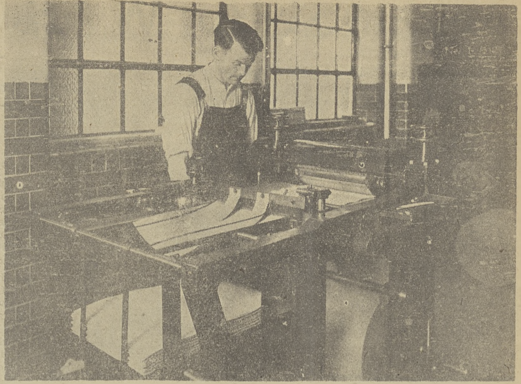
Płaska maszyna do drukowania znaków braille'owskich z płytek cynkowych.
