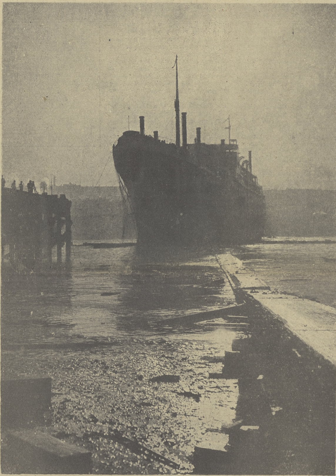
W Newcastle został spuszczonej na wodę nowy statek pasażerski — motorowiec „Rangitoto”. Statek wykonały zakłady Vickers Armstrong Ltd. Będzie on obsługiwał linię żegludową Zjednoczone Królestwo — Nowa Zelandia. „Rangitoto” ma 19.500 ton wyporności. Przystosowany jest nie tylko do przewożenia pasażerów, ale także i towarów. Na zdjęciu: „Rangitoto” po spuszczeniu na wodę.
