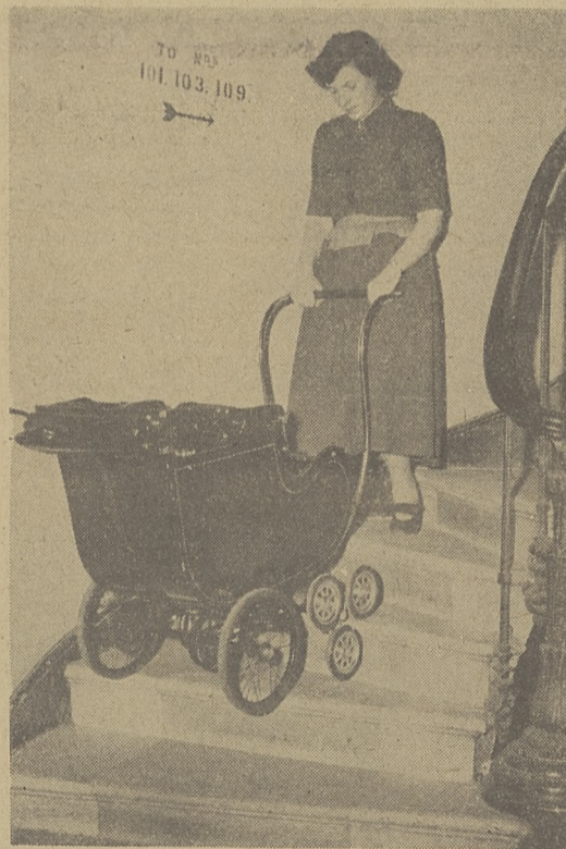
Niejaki pan Sagell z Londynu skonstruował wózek dziecienny, który dzięki trzem małym kółkom, umieszczonym z tyłu, można wygodnie sprowadzać po schodach. Na zdjęciu: nowy wózek dziecienny w „akcji”
