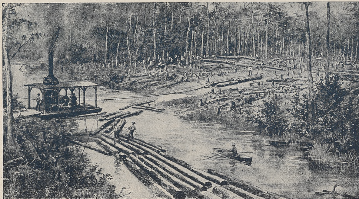
Wyciąganie drewna do splotu z lasu w terenie nizinnym za pomocą wyciągu dolnego.
