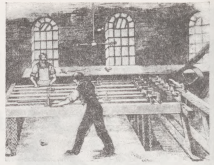
Mechaniczne wiercenie luf karabinowych w fabryce broni z II poł. XIX w.
