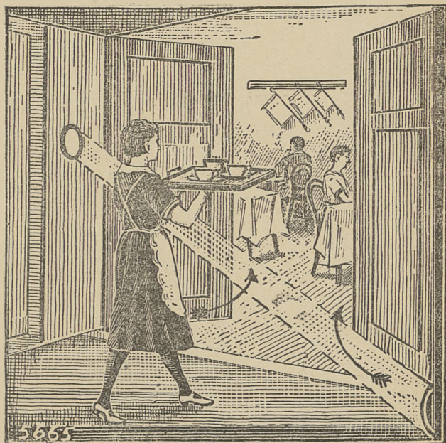
Niewidzialne promienie sprawiają, że przy zbliżaniu się osób, drzwi otwierają się automatycznie.
