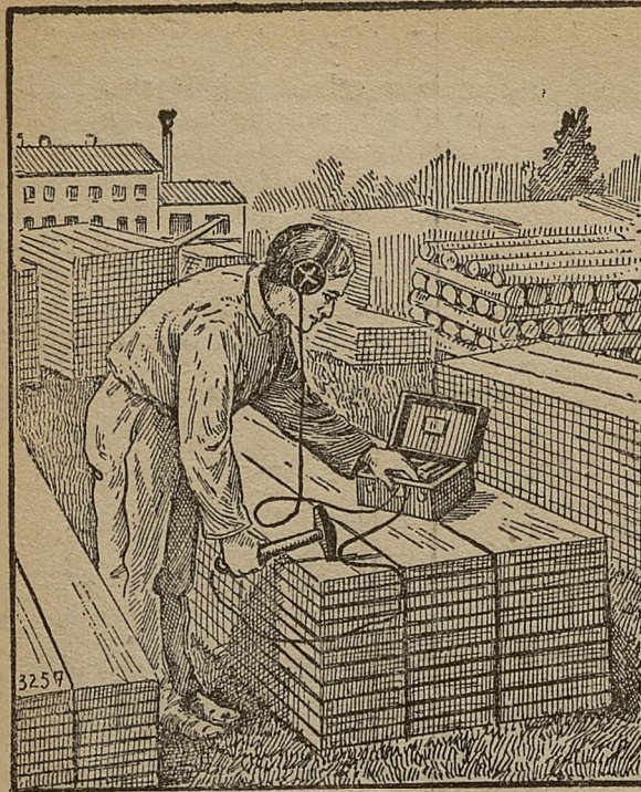
Technik bada z pomocą radia jakość betonu, kamieni, drzewa i przy pomocy radia odkrywa zgubne ich składniki, wilgość itd.
