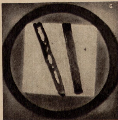
Widok szklanej pałeczki (na lewo) oraz rurki (na prawo) w jednolitym polu ultradźwiękowym.
