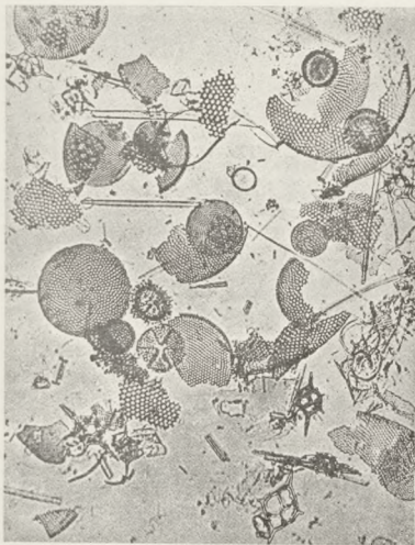
Rys. 33. Ziemia okrzemkowa, stosowana do celów filtracyjnych (wg. Calvert'a).
