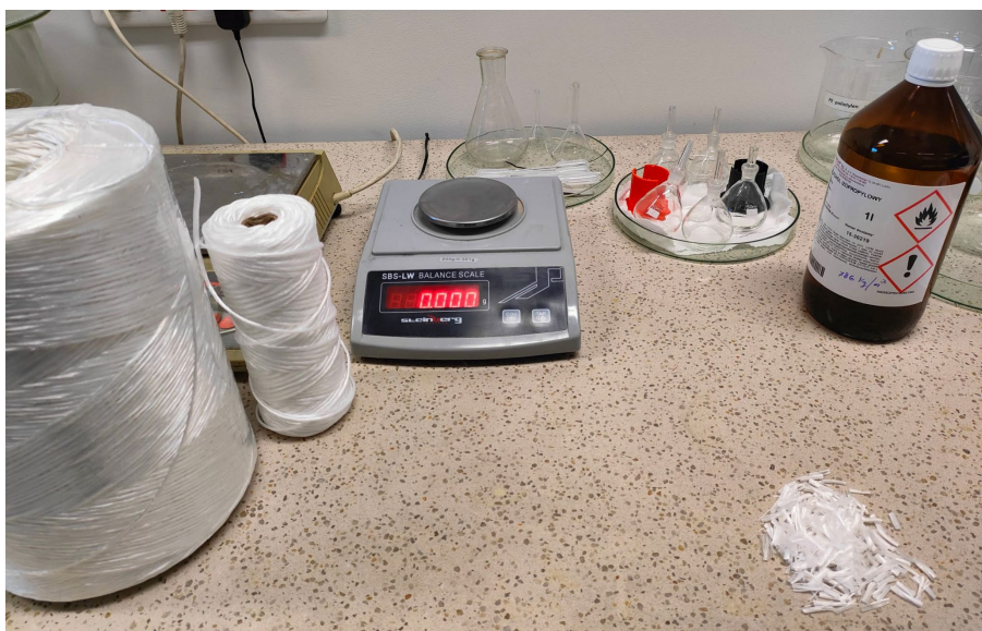
Ryc. 1. Stanowisko do pomiaru gęstości normalnej metodą piknometryczną (fot. J. Tomasiak)
